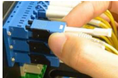
(1)コネクタ上部をプッシュ (2)コネクタ側面で挿抜 (3)専用タブで挿抜
