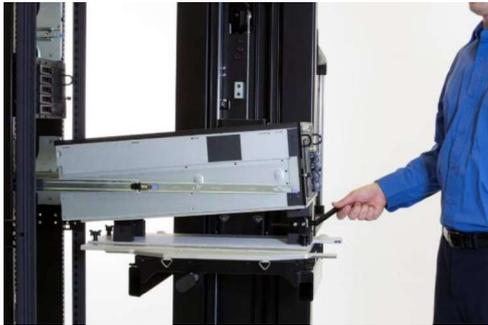
ドロップイン式のサーバーをマウント/アンマウントする際に使用します。
